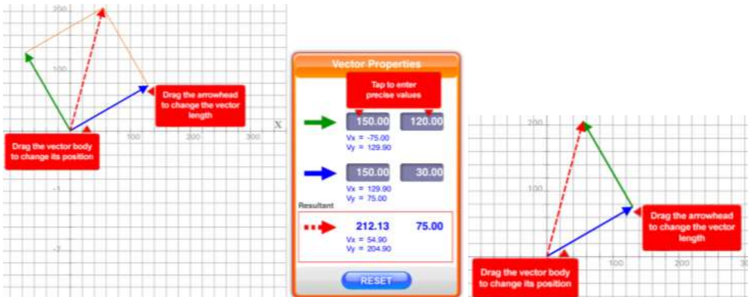
Slika 9. Sliki prikazujeta seštevanje nevzporednih sil po dveh pravilih; paralelogramskem (levo) in trikotniškem (desno). Velikosti in kote vektorjev lahko spreminjamo tako, da se s prstom dotaknemo vrha vektorja in ga povlečemo. Ob dotiku prijemališča vektorja vektor vzporedno premaknemo. Pri drugi možnosti ročno vpišemo velikost vektorja in njegov kot in tako dobimo rezultanto (črtkana črta).
