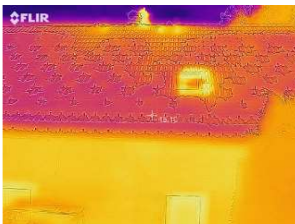
Slika 16: Velike izgube skozi strešno okno
