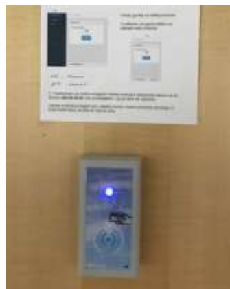
Slika 104: RFID čitalec kartic in obeskov
