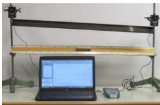
Slika 8: Postavitev eksperimenta za proučevanje kotaljenja kroglice po klancu.
