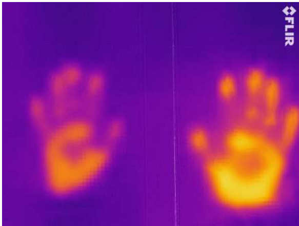
Slika 7: Toplotne sledi dlani na betonski steni (levo) in lesenih vratih (desno)
